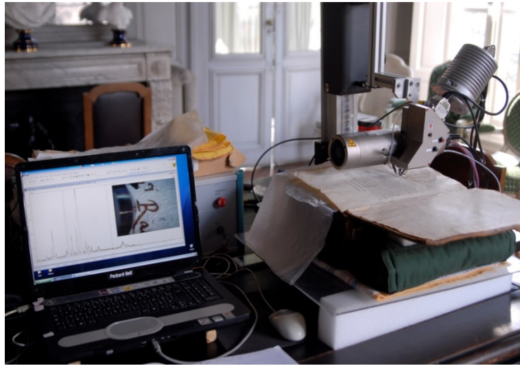
Fig.-1 : Spectrométrie de fluorescence X et ms. Fol BL 93 à la Bibliothèque de l'Arsenal
