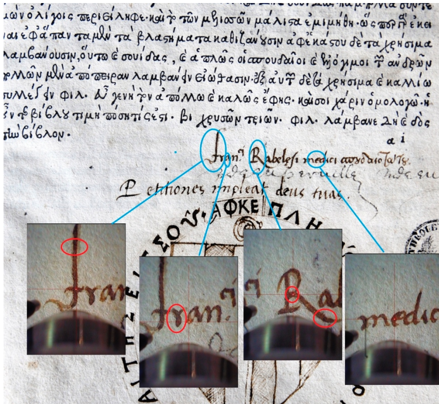
Fig.-3 : Exemple de la mesure de l'autographe les emplacements de mesures en spectrométrie de Fluorescence X sont matérialisés par le spot central et les mesures en spectrométrie d'Absorption par Réflexion diffuse à fibres optiques sont repérées par le tracé rouge
